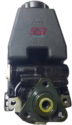
BOMBA BLAZER CON DEPÓSITO
